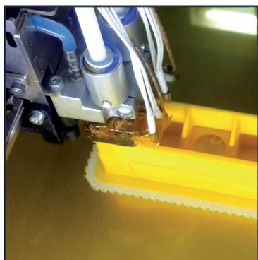
Famax Tech ha investito in sistemi di stampa 3D che consentono di poter realizzare, in tempi brevi e costi ridotti, prototipi e modelli di pre-serie. I materiali utilizzati sono polimeri tecno-plastici e polveri di metallo che consentono di produrre componenti con caratteristiche molto simili a quelli che saranno successivamente costruiti su larga scala.
